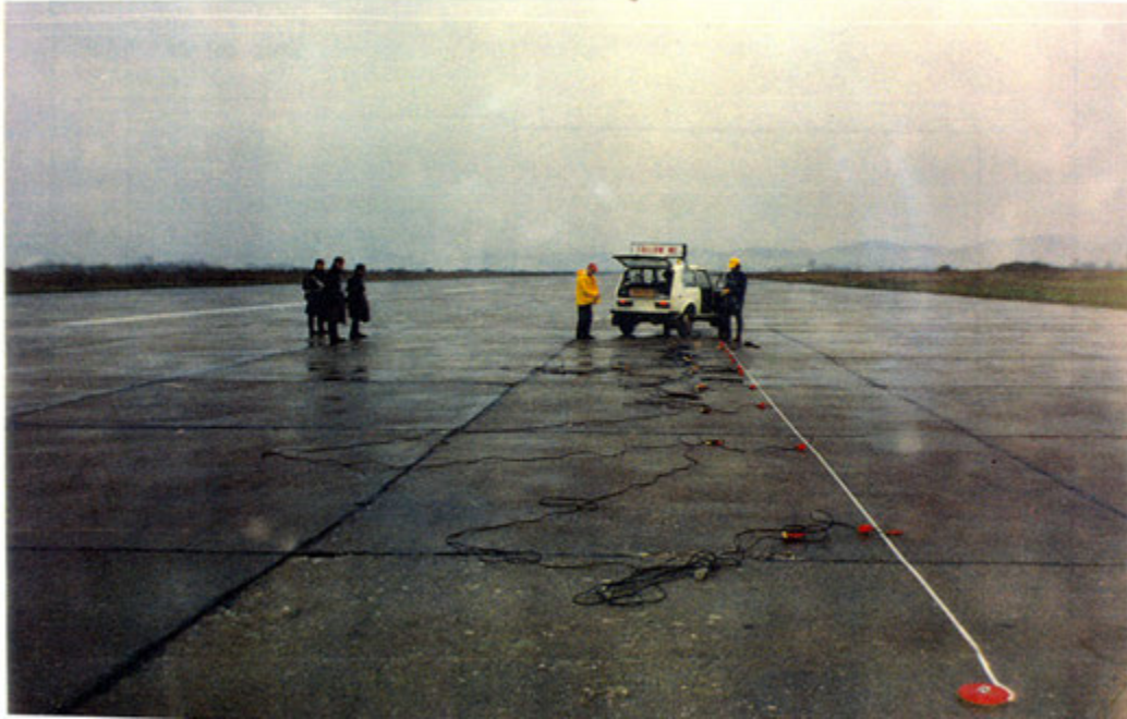
Foto 4.8. Kontrolli sizmik in-situ në pistën e Aeroportit Nënë Tereza, Rinas, Tiranë.
